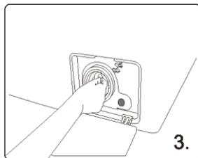
Установите крышку насоса и закрутите ее, чтобы убедиться в отсутствии утечки воды, как показано на рисунке. Наденьте защитную крышку!
