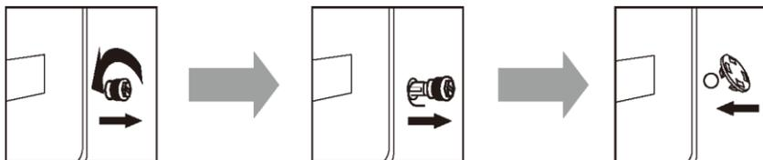
1. Ослабьте четыре транспортировочных болта гаечным ключом.
