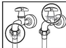
1. Подсоедините водяной шланг к водопроводному крану, а затем поверните соединитель по часовой стрелке, как показано на рисунке.
