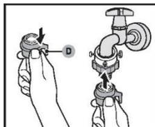
4. Вставьте переходник в водопроводный кран и затяните винты, поднимая переходник.
