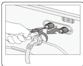
Отвинтите заливной шланг в задней части машины и вытащите фильтр плоскогубцами; установите его на место после очистки;
