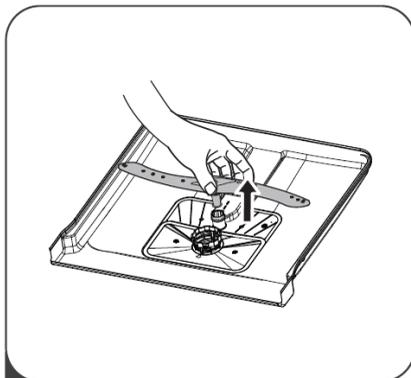
**2** Чтобы снять нижний разбрызгиватель, потяните его вверх.
