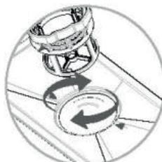
С. После промывки установите фильтр на место. Цилиндрический фильтр следует установить, повернув его по часовой стрелке до значков треугольника на фильтре, сетке фильтра и элемента из нержавеющей стали.
