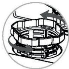
А. Поверните фильтр против часовой стрелки.
